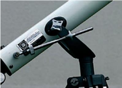
▲ La grande majorité des montures azimutales sont équipées d'une tige de contrôle lent.
