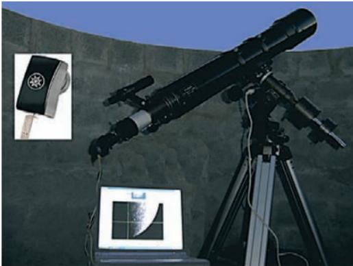
▲ Le capteur acquiert des images et les envoie sur l'ordinateur, où elles sont composées automatiquement pour affiner les détails.
