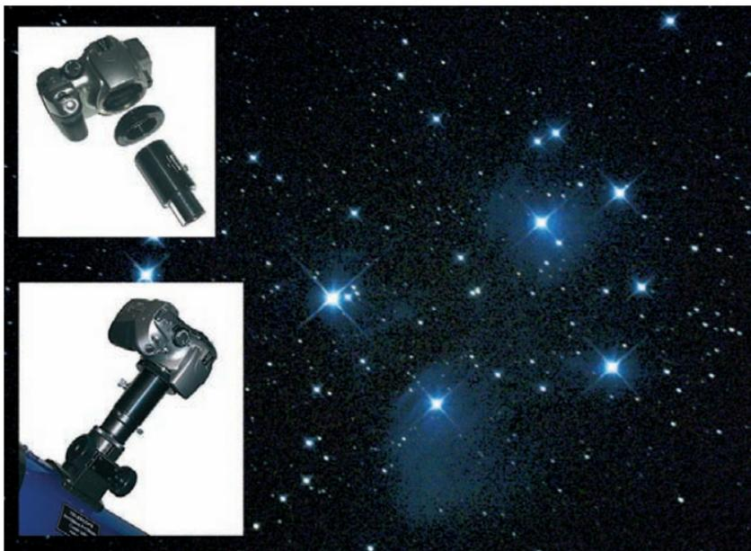
▲ L'instrument se transforme en un objectif photo.
