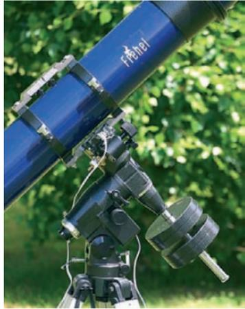
▲ La monture équatoriale allemande est généralement utilisée pour les lunettes et télescopes de Newton, caractérisés par des tubes longs.
